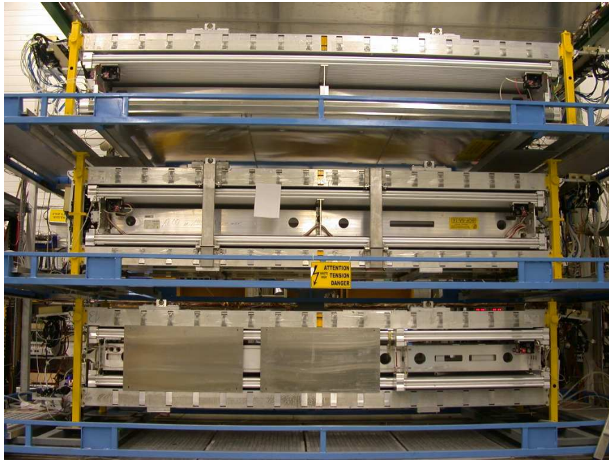
Abbildung 3.10: Bild des Höhenstrahlungsteststands am CERN. Drei Myonstationen können über Schubladen eingeschoben werden. Ober- und unterhalb des Kammerturmes befindet sich je eine RPC zum Auslösen der Datennahme beim Durchgang eines Myons aus der kosmischen Höhenstrahlung. Auf dem Bild sind, von oben nach unten, eine BOS-, BOF- sowie eine an der Universität Freiburg gebaute BOG-Kammer im Teststand zu sehen.
