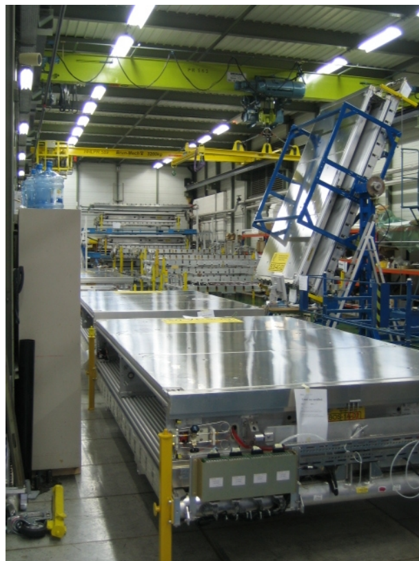
Abbildung 3.1: Blick in die Montagehalle BB5 am CERN in der sämtliche Tests sowie die Integrationen aller am MPI gefertigten Kammern mit den Triggerkammern durchgeführt wurden. Im Vordergrund befindet sich eine vollständig integrierte Myonstation (siehe Text).
