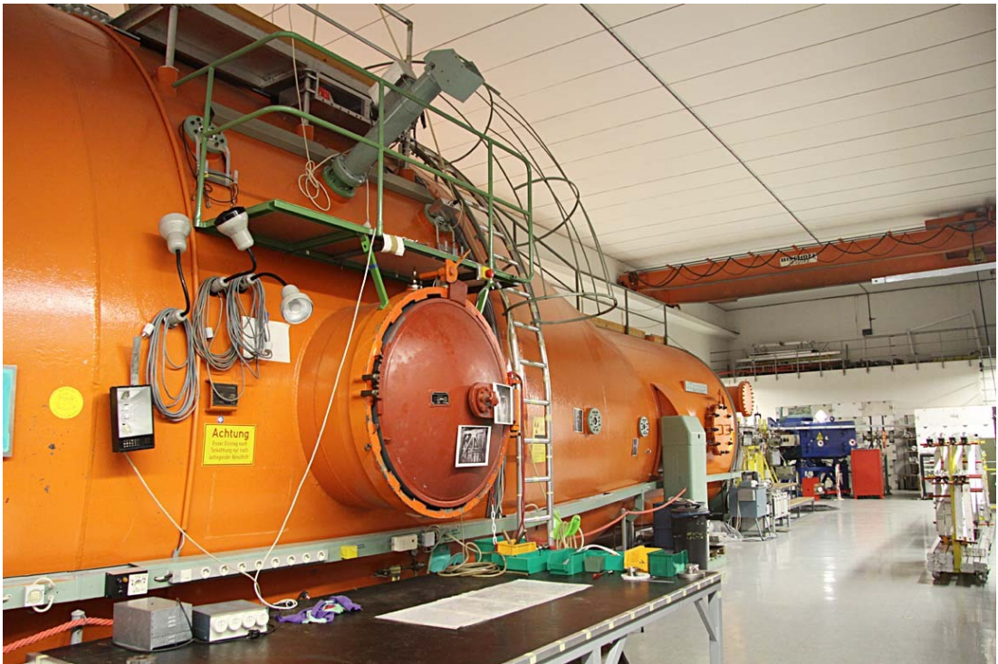
Abbildung 1.1: Blick in die Halle des Tandem-Beschleunigers in Garching. Hinten rechts ist blau der Ablenkmagnet zu sehen, welcher als Filter dient und den Strahl zur Experimentierhalle lenkt.
