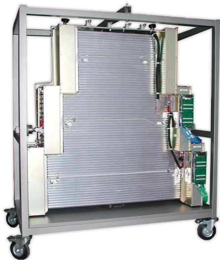
Gasverteilungssystem und Elektronikkarten
