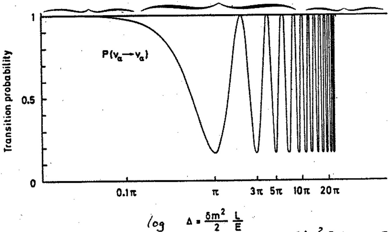
Laufzeitunterschiede wegen der unterschiedlichen Massen der Masseneigenzustände bei gleicher Energie führen zu zeitlichen Oszillationen zwischen den Neutrino flavours, wobei die Oszillationsfrequenz von der Massendifferenz abhängt.
