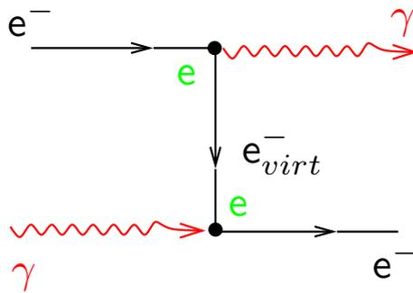
Elektron-Photon-Compton-Streuung:  $\sigma \propto \alpha^2$
