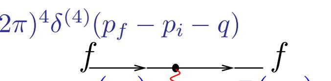
Fermion-Photon-Vertex:  $-ieQ_f \gamma^\mu (2\pi)^4 \delta^{(4)}(p_f - p_i - q)$
