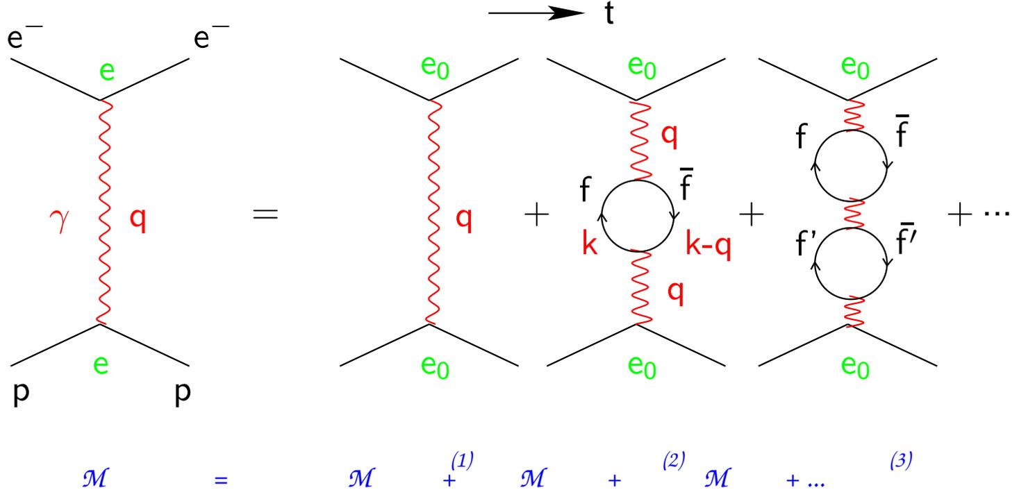
Die QED-Beiträge höherer Ordnung führen zu einer effektiven Modifikation des Photon-Propagators, die die **Form** des Resultats niedrigster Ordnung unverändert läßt:
