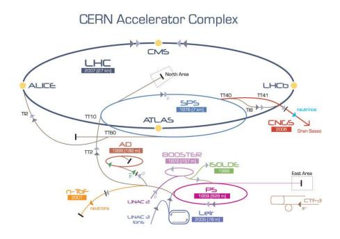
▶ p (proton] ▶ ion ▶ neutrons ▶ p (antiproton) → +→ proton/antiproton conversion ▶ neutrinos ▶ electron
